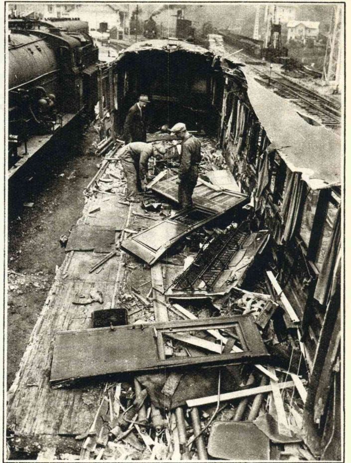
DE D-TREIN Parijs-Warschau verongelukte, door te groote snelheid op een in reparatie zijnd baanvak, tusschen Düren en Keulen. Deze foto toont hoe enkele wagons buiten de rails werden geplaatst.
