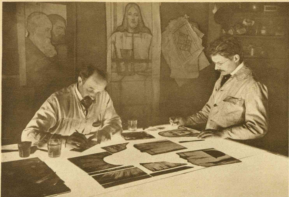
Het beschilderen der gesneden glasstukken boven den lichtbak.
